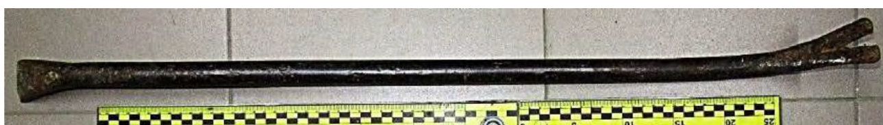
Рис. 9 Надана для дослідження монтажна лопатка зі цвяходером
