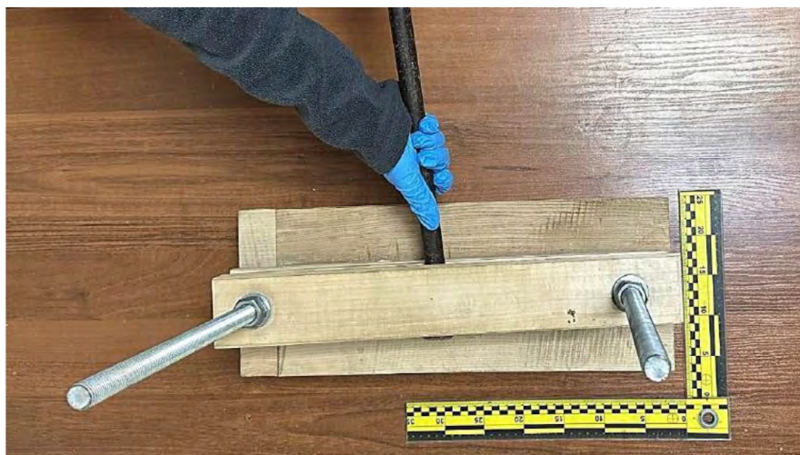
Рис. 7 Характерне розміщення робочої частини знаряддя на слідосприймальних елементах пристрою під час експертного експерименту
