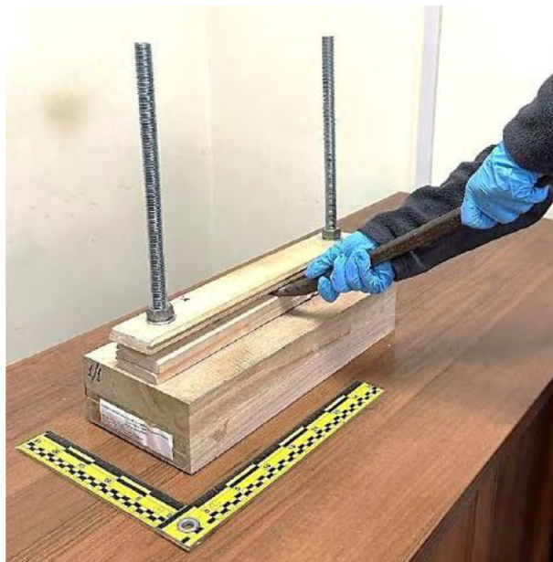
Рис. 6 Використання обладнання для імітації віджиму суміжних частин перешкоди й подальшого отримання експериментальних слідів під час трасологічної експертизи
