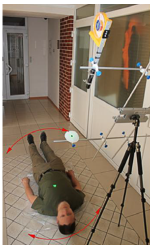
Рис. 8 Фіксування кута напрямку, у якому здійснено постріл, за допомогою кутоміра маятникового, механічного
