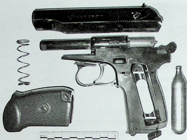
Рис. 21. Вид пневматического пистолета Макаров 654 К – 02 производства фирмы «Umarex» (Германия) при неполной разборке
