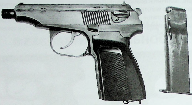
Рис. 3. Пистолет под патрон калибра 9 x 18 ПМ, изготовленный из пневматического газобаллонного пистолета МР – 654 К калибра 4,5 мм (с удлиненным стволом)
