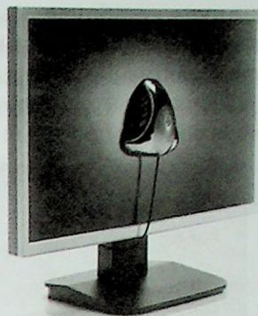
Рис. 2. Кріплення калібратора до монітора
