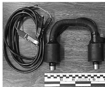
Рис. 3. Діючий пристрій для магнітно-порошкової дефектоскопії номерних знаків вузлів транспортних засобів
