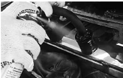
Рис. 4. Магнітно-порошкова дефектоскопія номерного знака транспортного засобу
