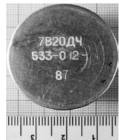
Рис. 14. Донна частина підривника 7В20 (РПГ-26)
