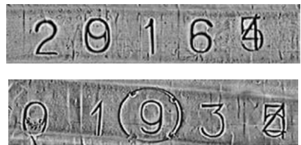
Рис. 5. Фотографія номерного знака з ознаками перебивання цифр
