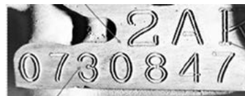
Рис. 6. Фотографія номерного знака з ознаками не заводського способу нанесення індивідуальних позначень окремих цифр номера двигуна: а – вигляд цифр заводського шрифту; б – виявлення конфігурації цифр, що не відповідає заводському шрифту
