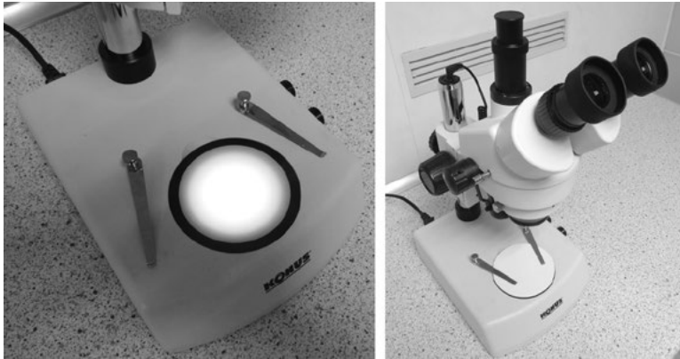
Рис. 1. Мікроскоп Konus Crystal 7–45x Stereo
