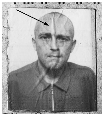
Рис. 10. Фотокартка зі змінним емульсійним шаром (стрілкою позначено жолоблення емульсійного шару)
