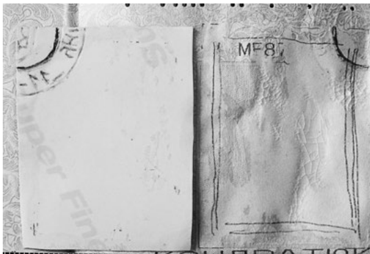
Рис. 16. Збільшене зображення місця розміщення фотокартки на сторінці паспорта після застосування відпарювання
