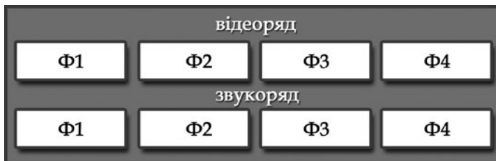
Рис. 3. Схематичне розміщення фрагментів відеоряду щодо фрагментів звукоряду у відеофонограмі «А»
