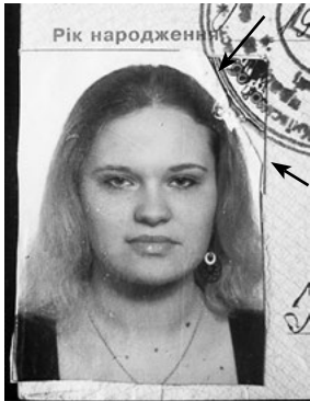
Рис. 11. Фотокартка з умонтованою частиною відбитка печатки (стрілками позначений умонтований фрагмент фотокартки)
