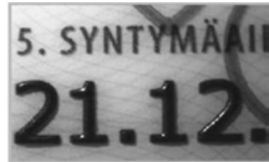
Змінні реквізити та фотозображення нанесено з використанням лазерного гравіювання; дату народження — тактильного лазерного гравіювання
