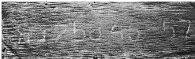
Рис. 5. Зображення ділянки на металевій рамці цівки мисливської рушниці з відновленим заводським номером
