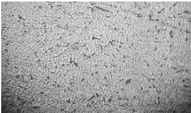
Рис. 2. Структура первинної рекристалізації металу оплавлення КЗ провідника № 1 (дислокація новоутворених кристалітів по межах розподілених інтерметалідів, x200)
