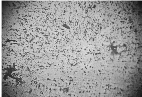
Рис. 1. Рівномірний розподіл інтерметалідів різного розміру в металі оплавлення КЗ провідника № 1 до травлення (x200)
