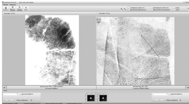
Рис. 13. Рабочее окно СПС в режиме проведения сравнительного исследования с активированным инструментом измерения расстояний (размеров). Результат выводится в режиме реального времени в поле над изображениями
