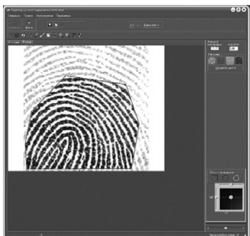
Рис. 6. Рабочее окно СПС в режиме применения графического фильтра «Контрастность-яркость» к выделенному участку вводимого изображения
