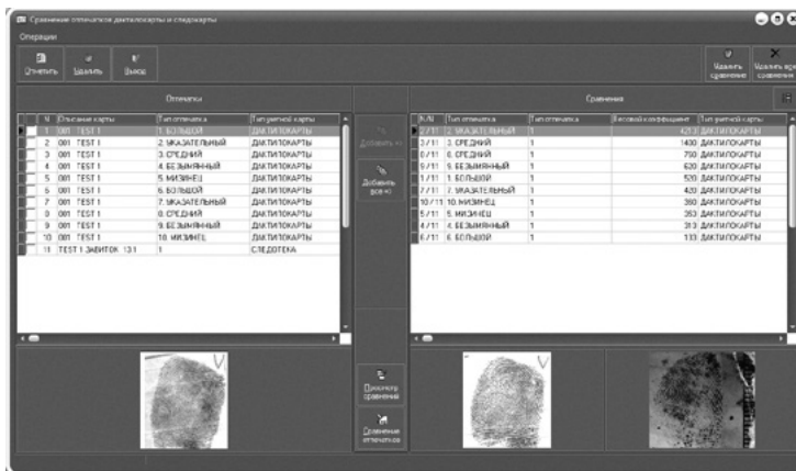
Рис. 9. Рабочее окно СПС со сформированным списком пар сравнения (один проверяемый след и 10 оттисков пальцев с дактилокарты), ранжированным по степени сходства между узорами (в правой части)
