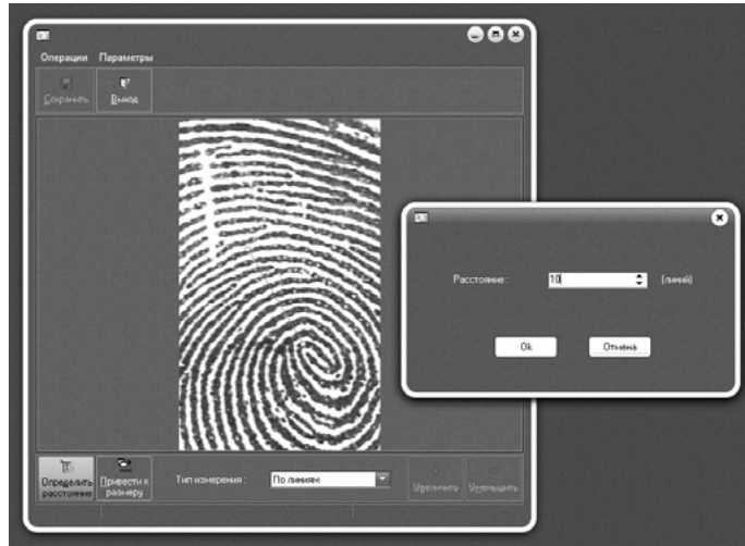
Рис. 3. Рабочее окно СПС в режиме определения масштаба следа на цифровом изображении по папиллярным линиям
