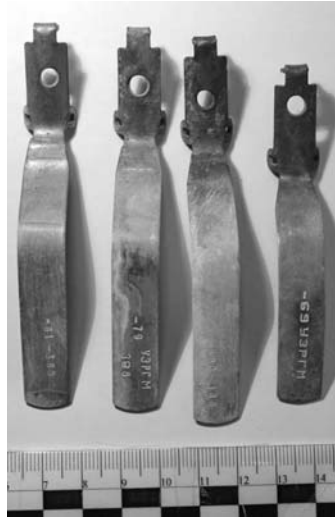
Рис. 27. Важелі після їх обробки за допомогою окису цинку (час — 4 год)
