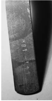
Рис. 20. Сліди пальців рук, виявлені за допомогою окису цинку на пофарбованій поверхні важеля зі слідами корозії (час — 2 год)
