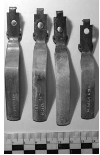
Рис. 28. Важелі після їх обробки за допомогою чотириокису рутенію (час — 4 год)
