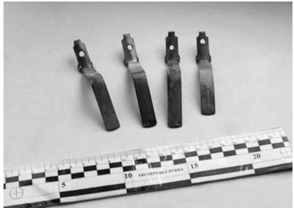
Рис. 2. Важелі, підготовлені для проведення експерименту (умови: кімната, температура — +21\text{ }^{\circ}\text{C} , відносна вологість — 80 %, відсутність протягів)
