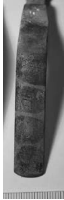
Рис. 17. Слід пальця руки, виявлений за допомогою сажі на непофарбованій поверхні важеля зі слідами корозії (час — 2 год)
