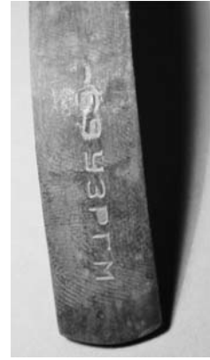
Рис. 21. Сліди пальців рук, виявлені за допомогою окису цинку на непофарбованій поверхні важеля (час — 2 год)
