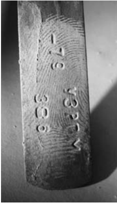
Рис. 19. Слід пальця руки, виявлений за допомогою окису цинку на непофарбованій поверхні важеля зі слідами корозії (час — 2 год)
