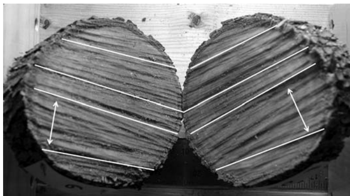
Рис. 14. Збіг напрямків слідів розпилу на досліджуваних фрагментах зрізаної деревини
