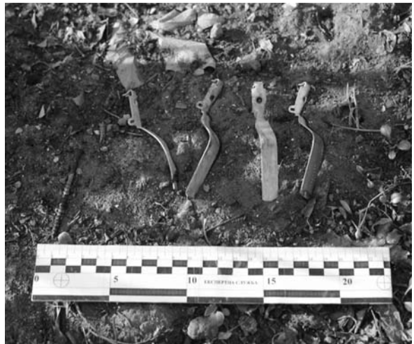
Рис. 4. Важелі, підготовлені для проведення експерименту (умови: поверхня відкритого ґрунту з незначним заглибленням, температура — +18\text{ }^{\circ}\text{C} — +25\text{ }^{\circ}\text{C} )
