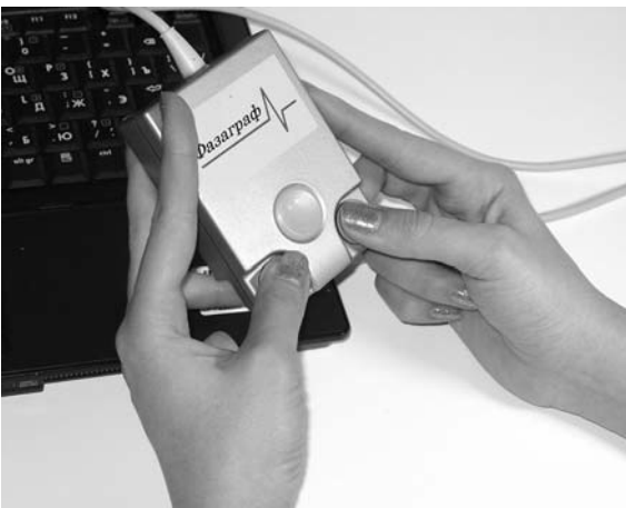
Рис. 6. Пристрій для реєстрації ЕКГ з пальцевими електродами
