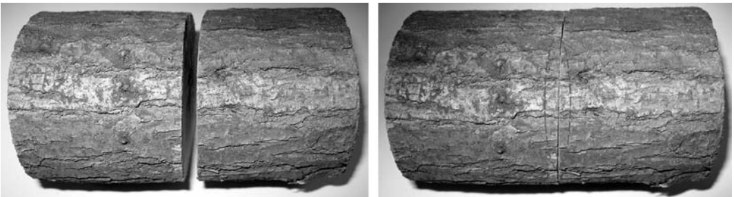
Рис. 3. Суміщення фрагментів деревини по поверхні розподілу
