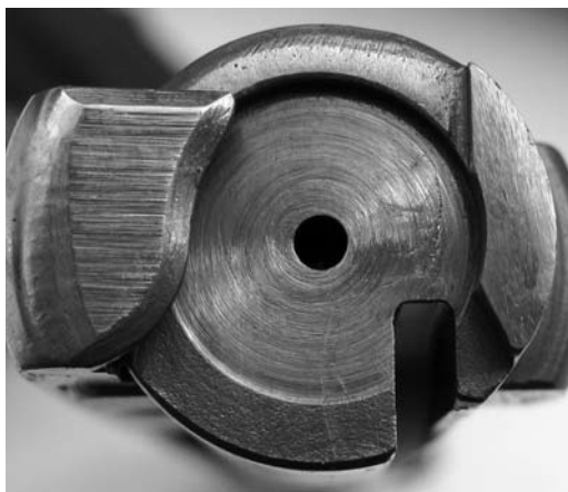
Рис. 3. Чашка затвора мисливського карабіна моделі «CZ 550»
