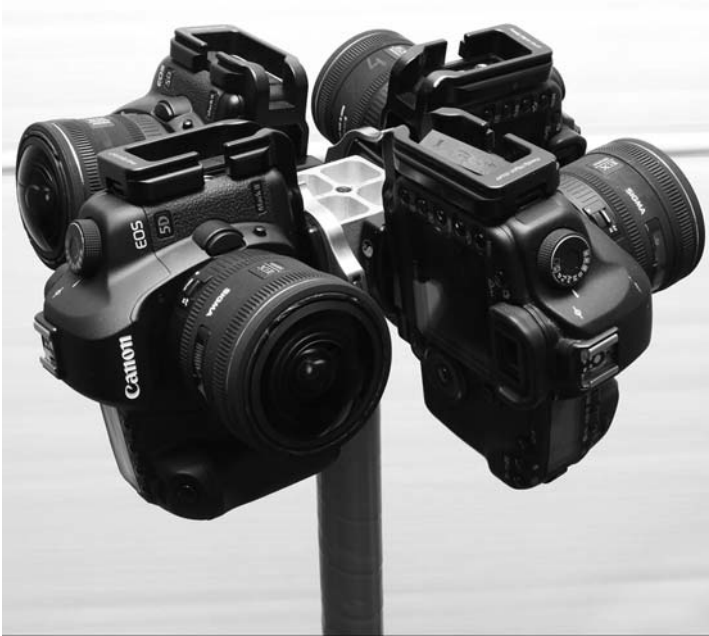
Рис. 4. Фотокамери Canon EOS 5D mark II з ширококутними об'єктивами на спеціальній конструкції для сферичної відеозйомки
