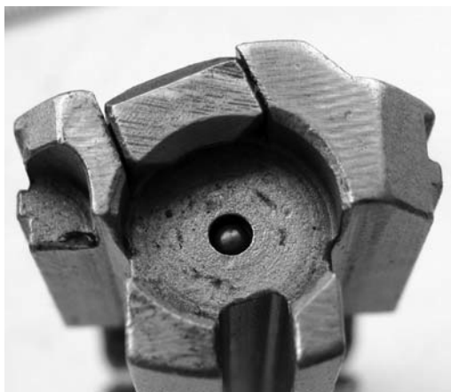
Рис. 4. Чашка затвора мисливського карабіна моделі «CZ 858»
