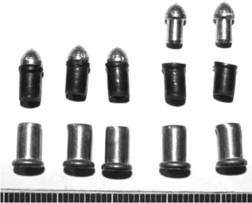
Рис. 2. Зображення переспоряджених патронів Флобера після демонтажу куль
