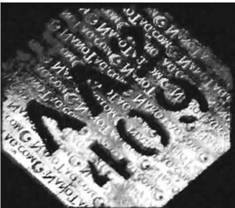
Рис. Збільшене зображення нікелевого диска із зображенням ідентифікаційного коду маркованого об'єкта
