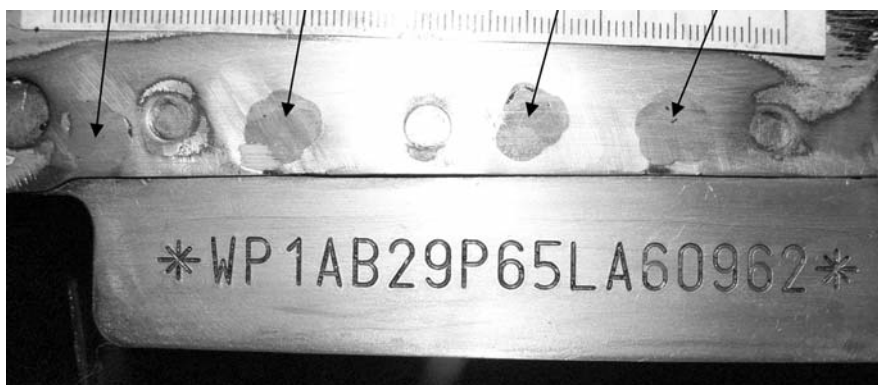
Рис. 7. Участок соединения номерной панели с кузовом автомобиля после химического травления
