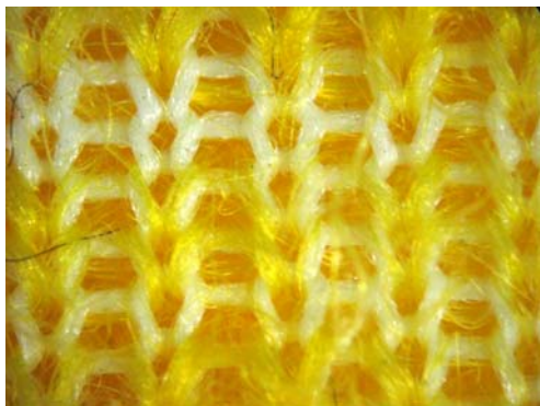
Рис. 2. Вид порока с изнаночной стороны меха
