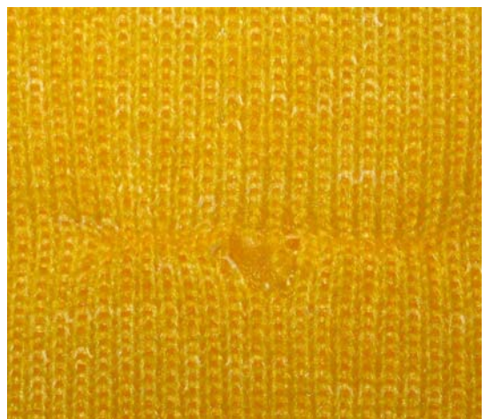
Рис. 15. Разрыв в результате зацепа (вид со стороны грунта)
