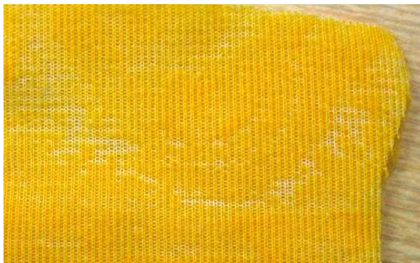
Рис. 1. Общий вид порока со стороны грунта
