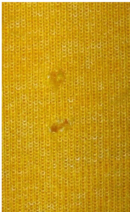
Рис. 16. Колотые повреждения: а – нанесенные крестообразной отверткой; б – нанесенные плоской отверткой (вид со стороны грунта)
