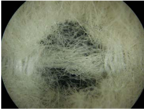
Рис. 13. Общий вид чесальной ленты в повреждении
