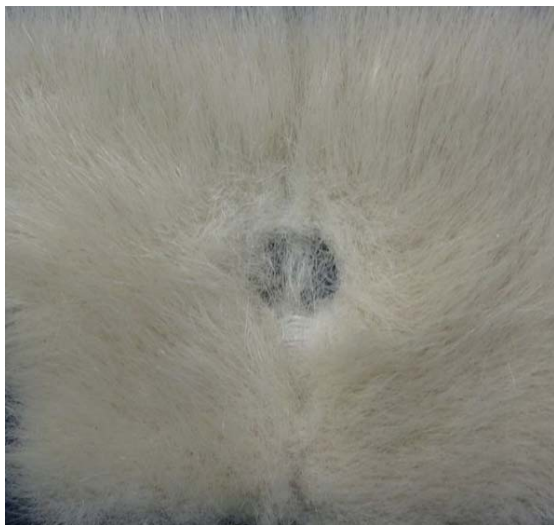
Рис. 10. Общий вид повреждения «дыра» с лицевой стороны
