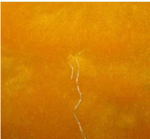
Рис. 14. Разрыв в результате зацепа (вид со стороны ворса)
