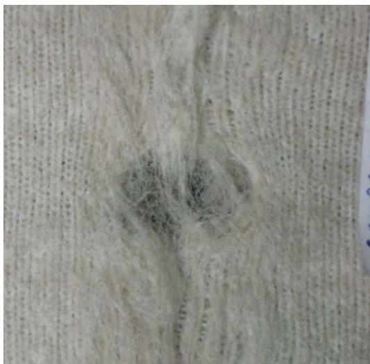
Рис. 9. Общий вид повреждения «дыра» с изнаночной стороны
