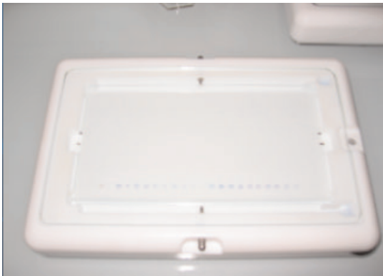
Рис. 1. Камера для горизонтального хроматографування
