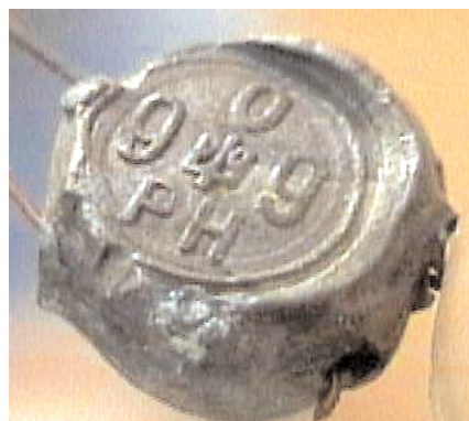
Рис. 2. Експериментальний зразок пломби, обтиснутої пломбувальними лещатами, що використовує підрозділ стандартизації та метрології Миколаївської області
