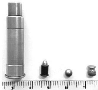
Рис. 2. Общий вид патрона “Air-Cartridge” и используемых в нем снарядов
