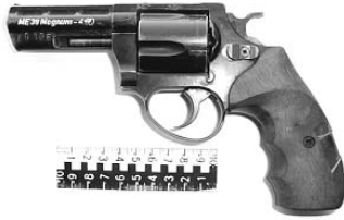
Рис. 1. Общий вид пневматического револьвера модели “ME 38 Magnum” калибра 4,5 мм, в котором используются патроны “Air-Cartridge”.
