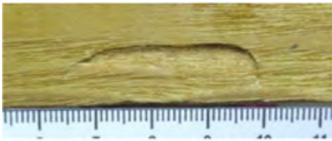
Рис. 13 Контрольне зображення сліду знаряддя зламу, виявленого на поверхні дерев'яної вирізки, вилученої під час огляду місця події
