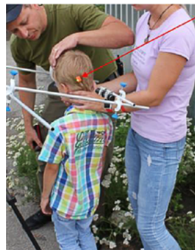
Рис. 10 Налаштування пристрою для балістичного візування напрямку пострілу під час визначення місця, з якого здійснено постріл
