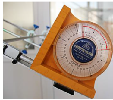
Рис. 9 Фіксування кута напрямку, у якому здійснено постріл, кутоміром маятниковим, механічним
