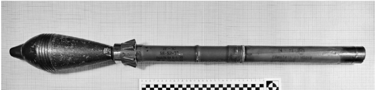
Рис. 1. Саморобний вибуховий пристрій на основі корпусу 82-мм мінометної міни та маршового і стартового порохових двигунів пострілу ПГ-7ВЛ
